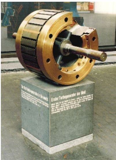
Abb. 1. Rotor des BBC-Turbogenerators von 1898
